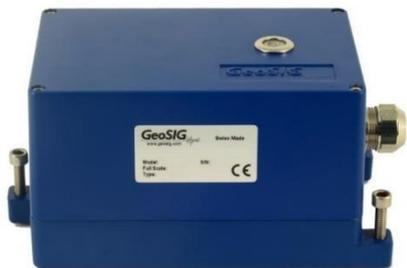
Сейсмометры **VE-53** базируются на геофонах с массой, подвешенной на растяжках с электронной системой обратной связи. Он идеально подходит для установки в шахтах с низким или умеренным шумом. Обладает высокой устойчивостью к изменениям температуры, не подвержен «старению», не требует арретирования.
