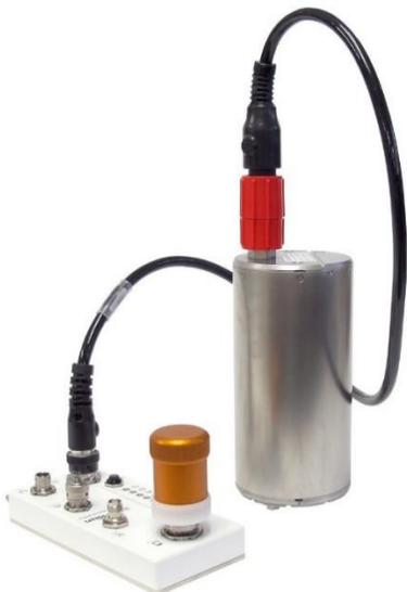
Объединенная система из датчика **Trillium Compact** и дигитайзера второго поколения является новейшим достижением в разработке скважинных инструментов. При этом компактные размеры прибора нисколько не влияют на качество и эффективность его работы.
