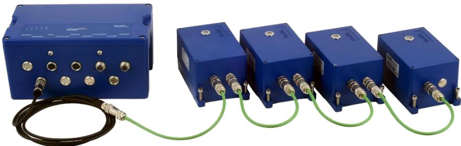
Многоканальная распределенная система цифровых датчиков GeoSIG является экономически эффективным и удобным инструментом сейсмического и вибрационного мониторинга в нескольких точках, расположенных на расстояниях в десятки и сотни метров друг от друга. Данная аппаратура идеально подходит для мониторинга крупных инженерных объектов: плотин, мостов, стадионов и других протяженных и/или высотных объектов.
