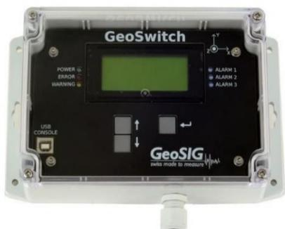
GeoSwitch является полноценным сейсмическим выключателем, состоящим из матрицы трехкомпонентных акселерометров, расположенных по технологии GeoSIG RQM™, цифровой схемы детектирования превышения заданного порога ускорений для трех независимых уровней, выходных реле и запасного источника питания.
