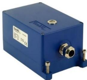
Акселерометры данной серии являются серво-акселерометрами, основанными на стандартных геологоразведочных геофонах с массой, подвешенной на пружинах с электронной системой обратной связи. Благодаря простоте конструкции, датчик типа АС-23 отличается высокой устойчивостью по отношению к изменениям температуры и не подвержен «старению», требует минимального обслуживания.
